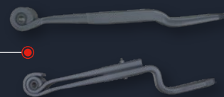
■ Полурессоры (рычаги) пневмоподвески
